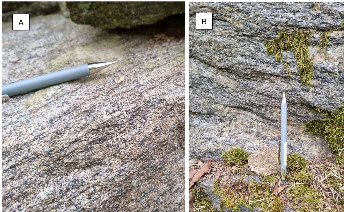
Figur 9 A. Rödgrå gnejs med tydlig foliation i områdets östra del. B. Grå-rödgrå granitoid utan tydlig foliation i detaljplaneområdets västra del, en av slänterna invid gångvägen mellan Gärdmosseskolan och Galaxen.
